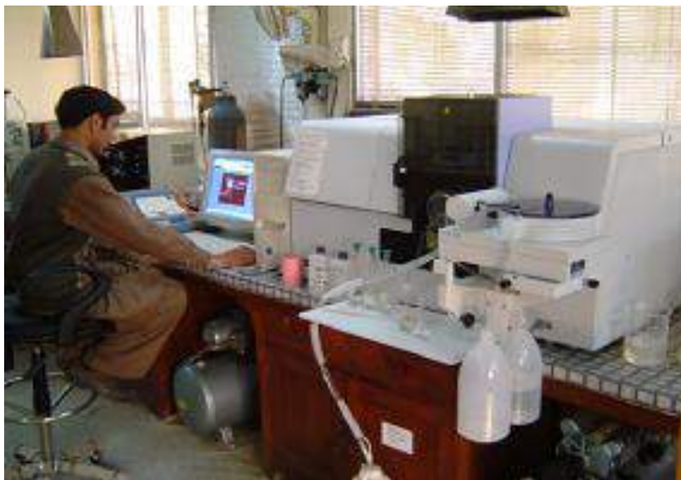
Fig. 2.6. Atomic absorption spectrometer (AAS) modal AAS-PEA 700.
